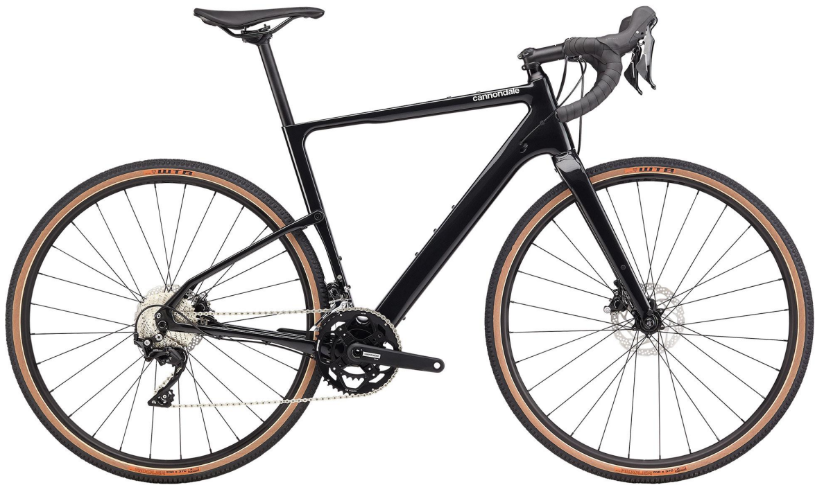
Cannondale Topstone umožňuje pružení zadní stavby díky napojení sedlové vzpěry čepem
